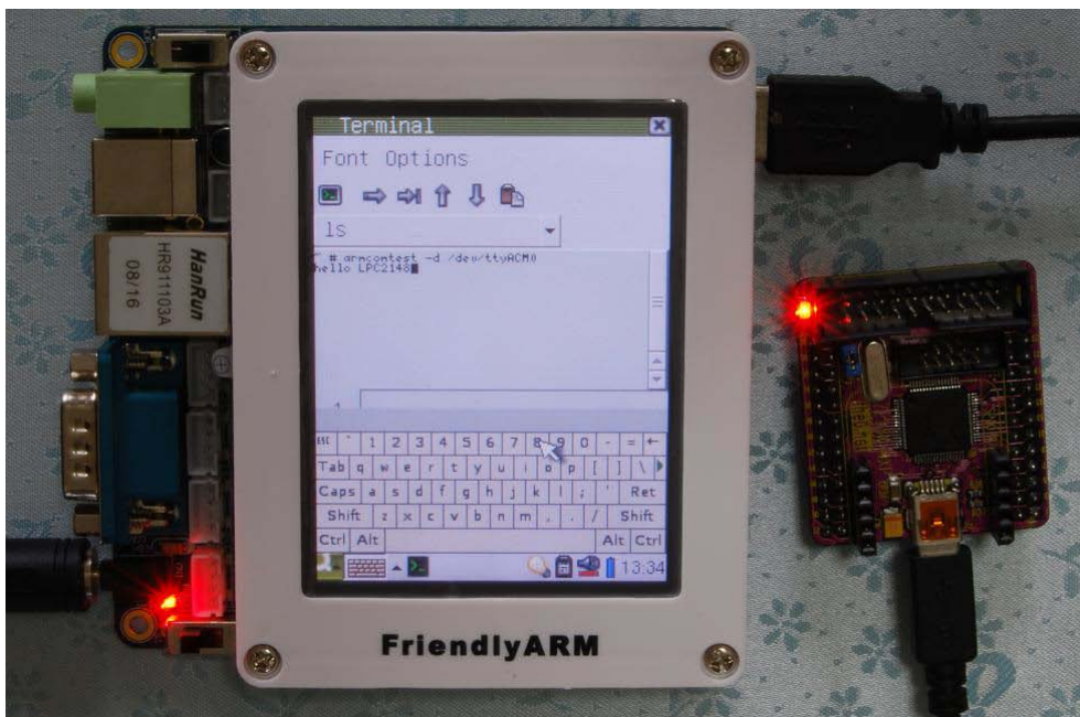
ARM9 が ARM7TDMI/LPC2148 を USB で通信する様子
