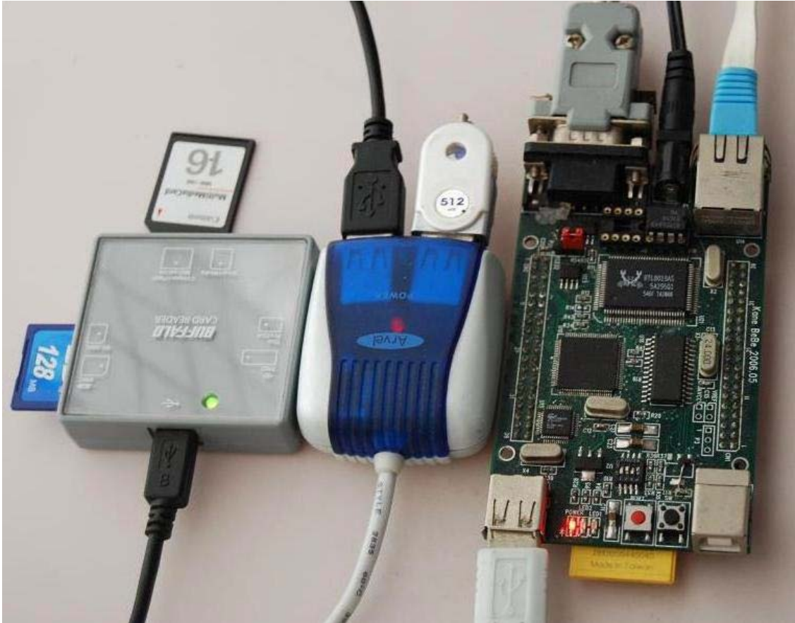
uClinux が動く様子(H8KANE と USB-HUB と CARD READER)
