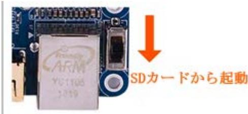
Step4: システム書き込み完成後、開発ボードの S2 スイッチを `Nand` 起動に切り替え、reboot し、新しい Linux システムが起動する。
