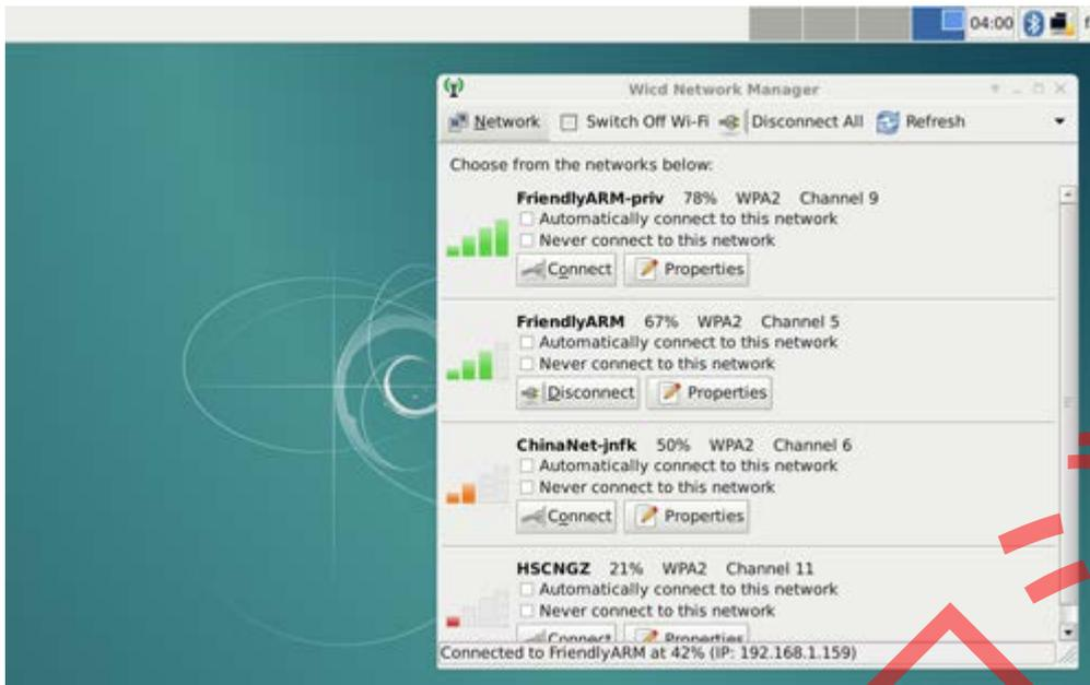
次の内容は[-wifiap. img]ファイルで実行されるNanoPC-T2のみに適用される。デフォルトではWiFiのAP(アクセスポイント)モードはオンになっているため、無線ルーターに接続できない。以下の手順でWiFiのAPモードをオフにする。
