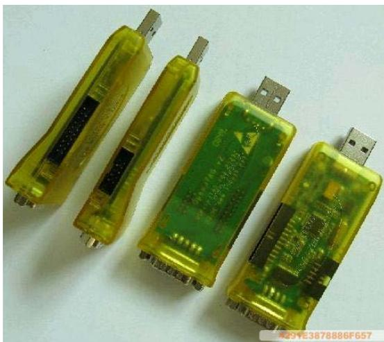
弊社が販売している Open-JTAG は ARM 用の USB-JTAG エミュレータです。ARM7、ARM9、Cortex-M3、XSCALE に対応、OpenOCD をサポートします。USB-RS232 機能もあります。COM と LPT ポートがないノートパソコンに最適。
