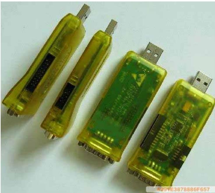
Open-JTAG は ARM 用の USB-JTAG エミュレータです。ARM7、ARM9、Cortex-M3、XSCALE に対応、OpenOCD をサポートします。USB-RS232 機能もあります。COM と LPT ポートがないノートパソコンに最適。
