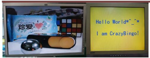
ビデオが7秒再生した後、第8秒に「Hello World^-^, I am CrazyBingo!」の文字列が表示される。 上記正しい現象でしたら、CMOS回路及びVGA回路部分は正常に動作している。
