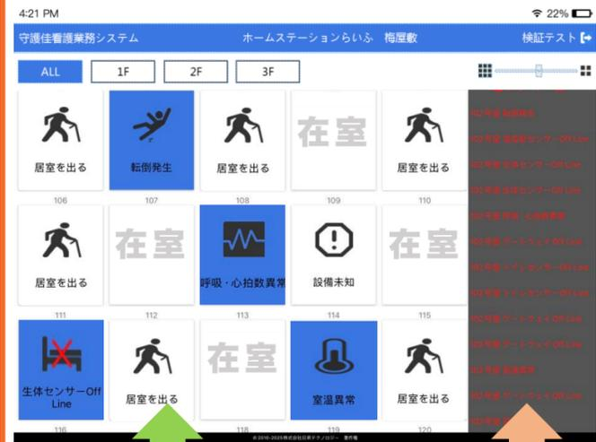
iPad端末には、居室一覧の画面で、リアルタイムの居室状況をアイコン表示で確認します。右側のアラート一覧で、転倒などの情報を文字と音で通知します。
